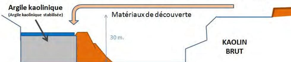
A partir de la fin 2015, la société SOKA a créé dans la masse des argiles kaoliniques des bassins. Désormais, les produits de lavage des kaolins sont déposés, en alternance, dans 2 bassins de décantation, d'un volume unitaire d'environ 5 000 m<sup>3</sup>. Les argiles kaoliniques sont ensuite reprises à la pelle hydraulique. Les eaux de surface sont réinjectées dans le circuit des eaux de process après passage dans 2 bassins de clarification, d'un volume unitaire d'environ 3 000 m<sup>3</sup>.
