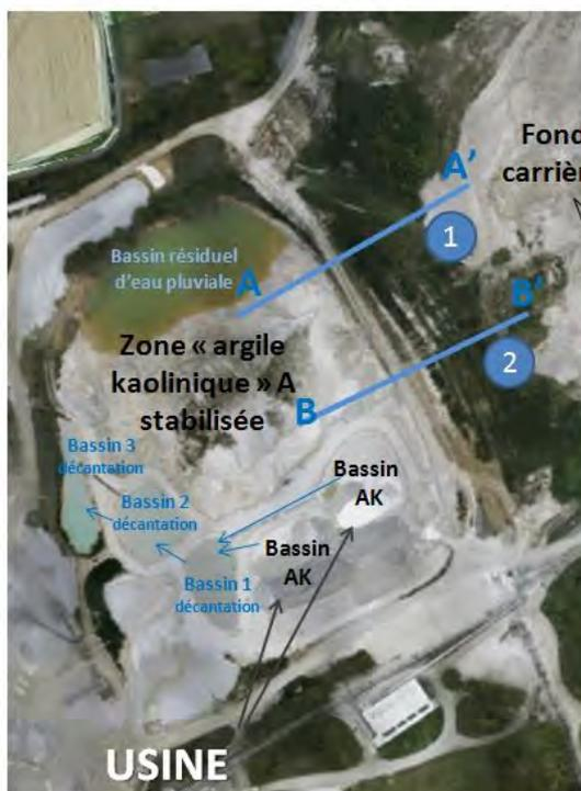
**Process de fabrication de l'argile kaolinique par décantation depuis 2016**
